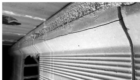
Nella precedente immagine di sinistra è ben visibile la frattura dovuta alle tensioni che si sono concentrate, in basso, in corrispondenza dello spigolo creato dal disegno della pignatta; nell'immagine di destra la frattura è stata provocata nella posizione opposta, in alto, ed anche in tal caso legata alla particolare forma svasata.
