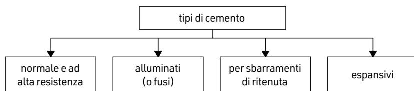
Figura 4.2. Classificazione del cemento [2]
