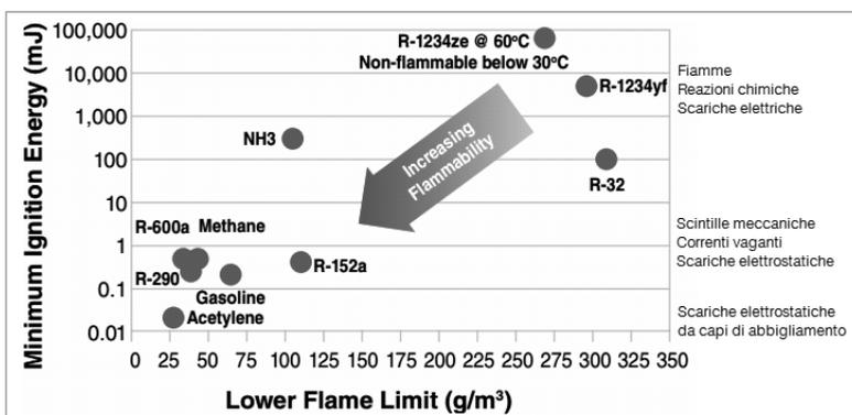
Figura 10.1. Caratteristiche di infiammabilità di alcuni gas refrigeranti
