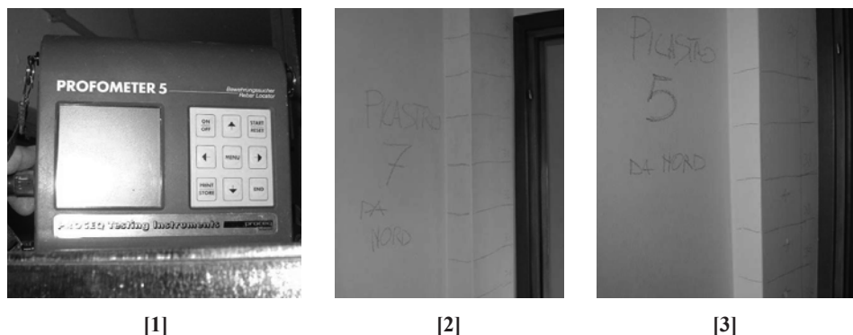
Figura 11.1. Pacometro [1], individuazione ferri d'armatura P7 [2] e individuazione ferri d'armatura P5 [3]
