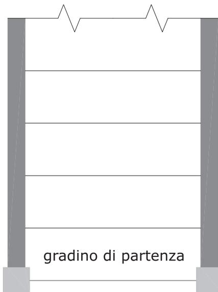
**Gradino intermedio:** gradino compreso tra il gradino di partenza ed il gradino di sbarco.
