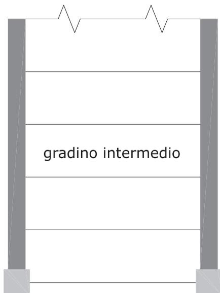
**Gradino di sbarco (caposcala, stangone):** ultimo gradino al termine superiore della scala.
