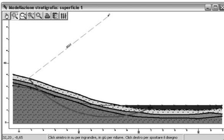
Le figure successive si riferiscono invece alla discretizzazione in strisce e ai dettagli grafici presenti sul disegno, come i diagrammi delle tensioni sulla superficie di rottura e l'indicazione della forze agenti sulla singola striscia.
